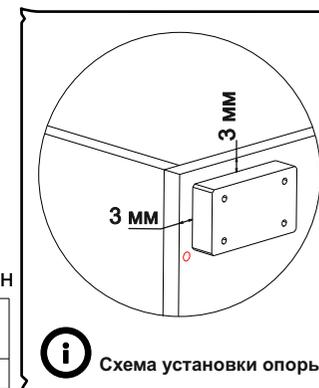
**i** Схема установки опоры
