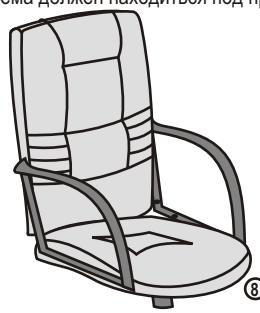
6. Сиденье установите отверстием в металлической площадке на газпатрон.
