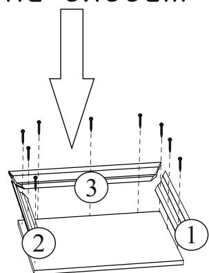
Карниз рекомендуется крепить в последнюю очередь, с помощью шурупов 4x25. Строго соблюдая угол 45 градусов между элементами карниза
